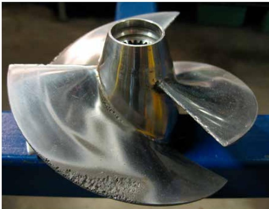
d'urto e una turbolenza altamente distruttive. Le bolle di cavitazione si formano, generalmente, in prossimità di particelle di solido disperse nel liquido: per questo motivo, come vedremo in seguito, gli ultrasuoni possono essere utilizzati per tutte le applicazioni elencate all'inizio.
