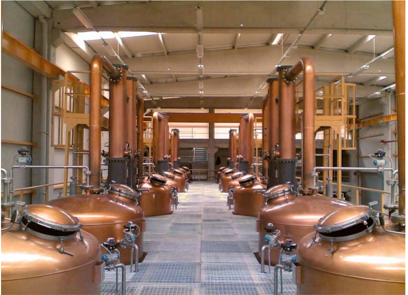
siva fermentazione con colture di lieviti selezionati. L'anidride carbonica che si sviluppa durante la fermentazione contiene una percentuale di alcol che non può essere disperso nell'atmosfera. I gas alcolici vengono convogliati in una wash column dove l'etanolo viene recuperato e riconvogliato nei tini di fermentazione. Il Raki ottenuto da un mix di Suma e alcol neutro è miscelato nella misura di 65:35% e sottoposto a taglio di teste e code di distillazione.
